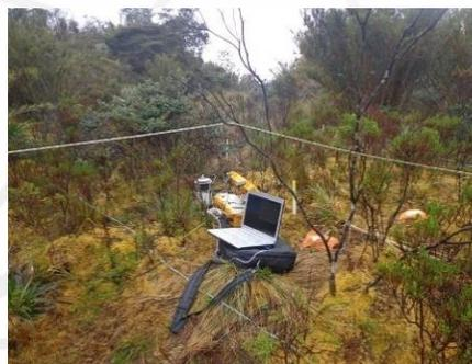
Instalación de los equipos de lectura de CO<sub>2</sub> (Licor8100) para la medición de flujos de CO<sub>2</sub> en los diferentes tipos de cobertura (Bosque y Páramo) (IDEAM, 2015).
