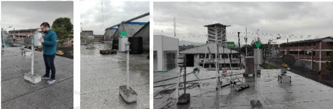
Figura 26. Proceso de instalación del totalizador Palmex en las instalaciones del nuevo Laboratorio de Calidad del IDEAM.
