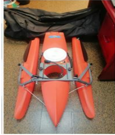
Accesorios y partes del medidor de caudal líquido - ADCP. Metodología efecto doppler
