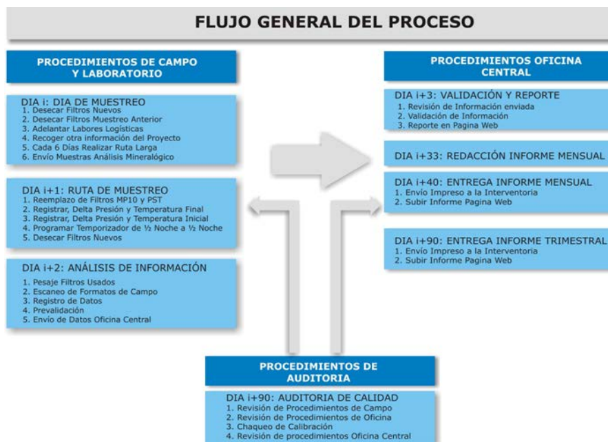
Figura 3. Ejemplo flujo de proceso de un SVCA Manual 1
