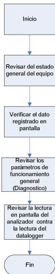
Figura 27. Proceso de revisión del analizador de monóxido de carbono (CO)
