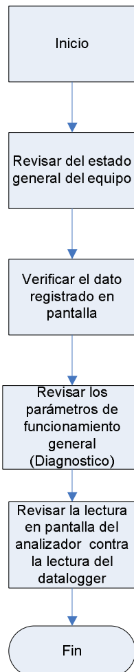
Figura 24. Proceso de revisión del analizador de dióxido de azufre (SO 2 )
