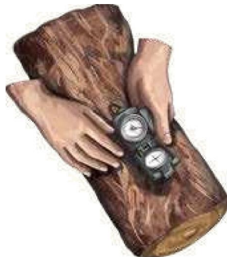
Figura 52. Medición de la inclinación y orientación
