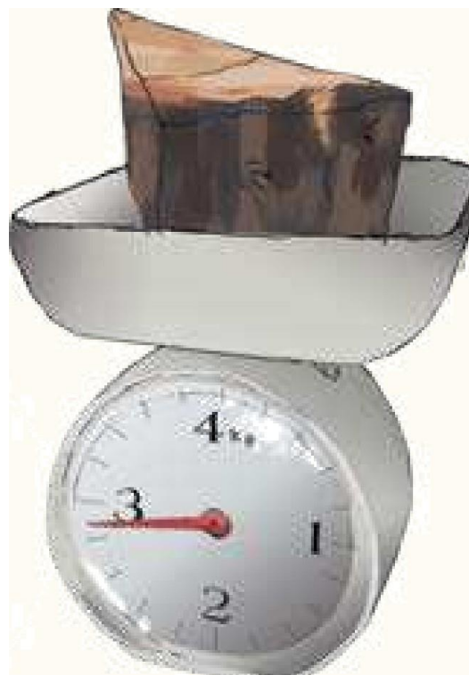
Figura 56. Subdivisión y pesaje de muestra de rodaja
