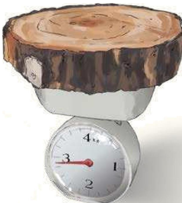
Figura 56. Subdivisión y pesaje de muestra de rodaja
