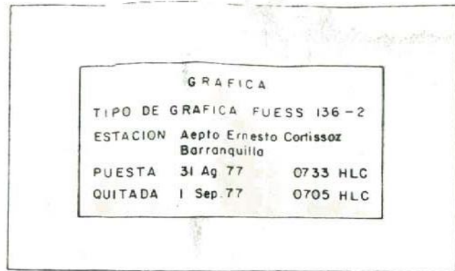
e) ANOTAR CON LAPIZ EL DIA, MES, AÑO Y HORA EXACTA EN QUE SE HA QUITADO LA BANDA
