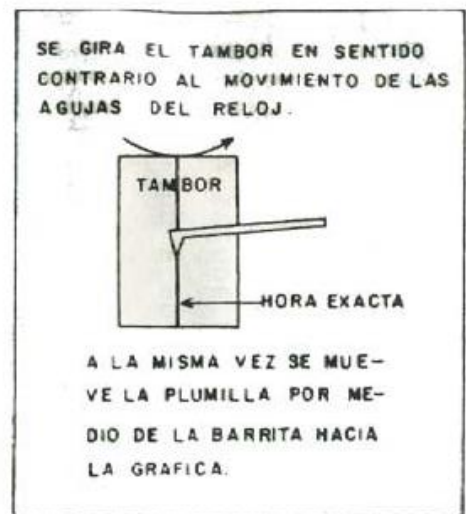
l) COLOCAR EL TAMBOR Y LA PLUMILLA SOBRE LA HORA EXACTA.
