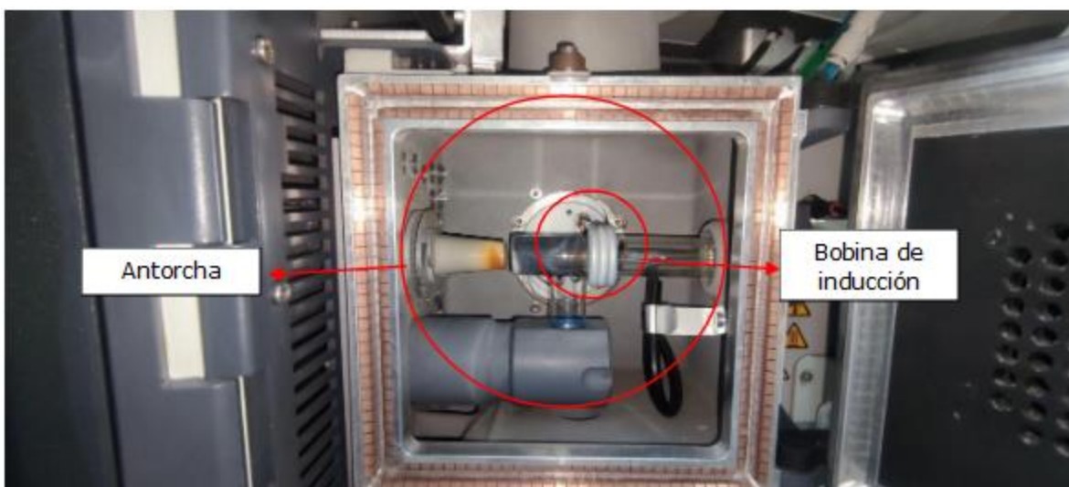
Ilustración 3. Interior de la cámara de la antorcha
