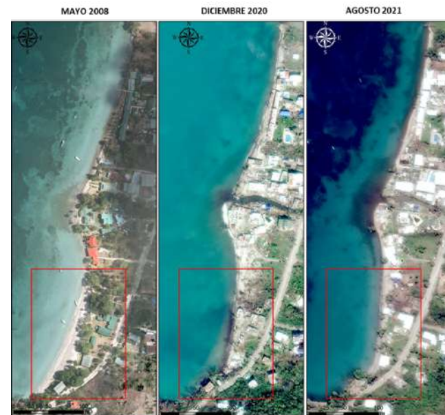
► Figura 2.107. Cambios en la posición de la línea de costa en el sector de Agua Dulce (Providencia)
