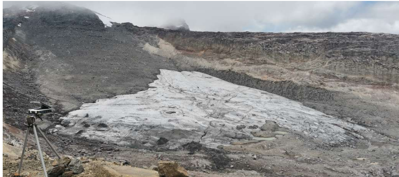
► Figura 2.60. Cámara de fotoseguimiento glaciár en el Nevado de Santa Isabel, PNN Los Nevados
