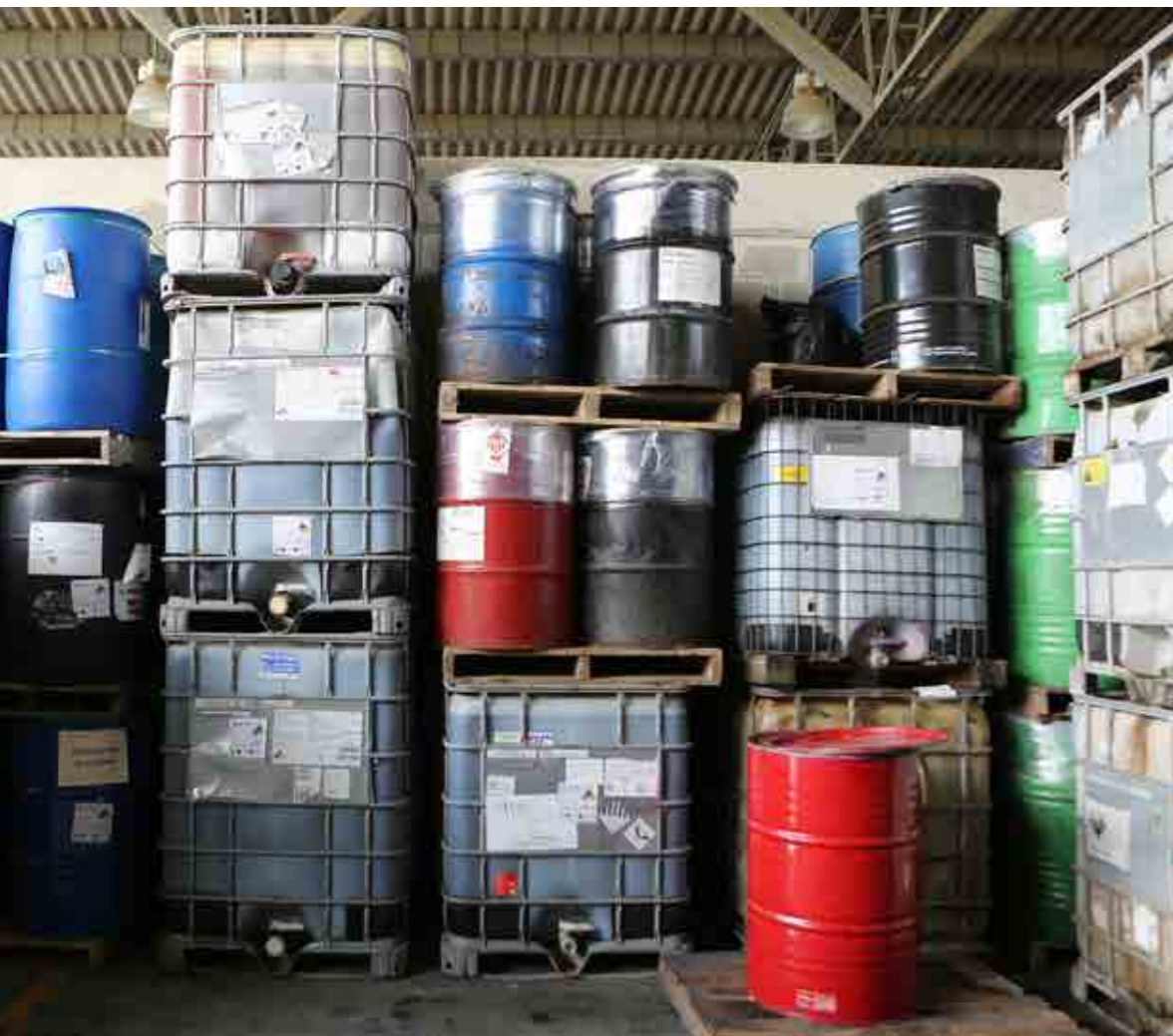
▲ Foto: Almacenamiento de residuos peligrosos Cortesía: Minambiente
