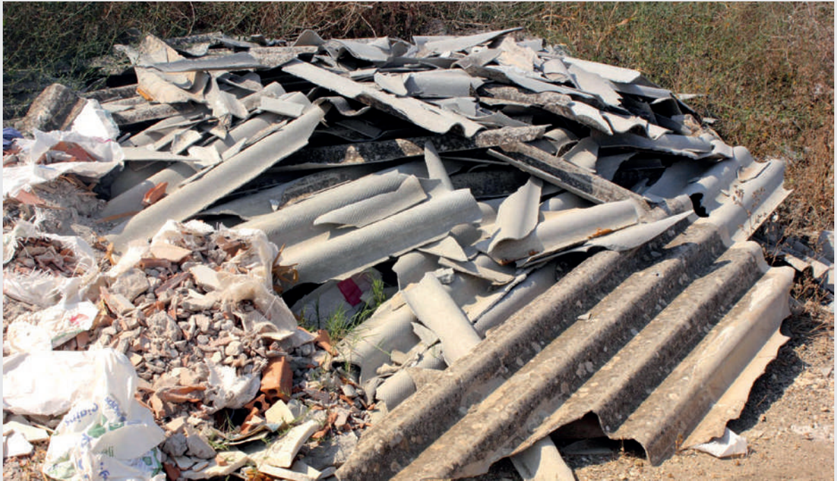
Residuos de tejas de asbesto dispuestas a campo abierto. Imagen: Mark Benford / 123RF
