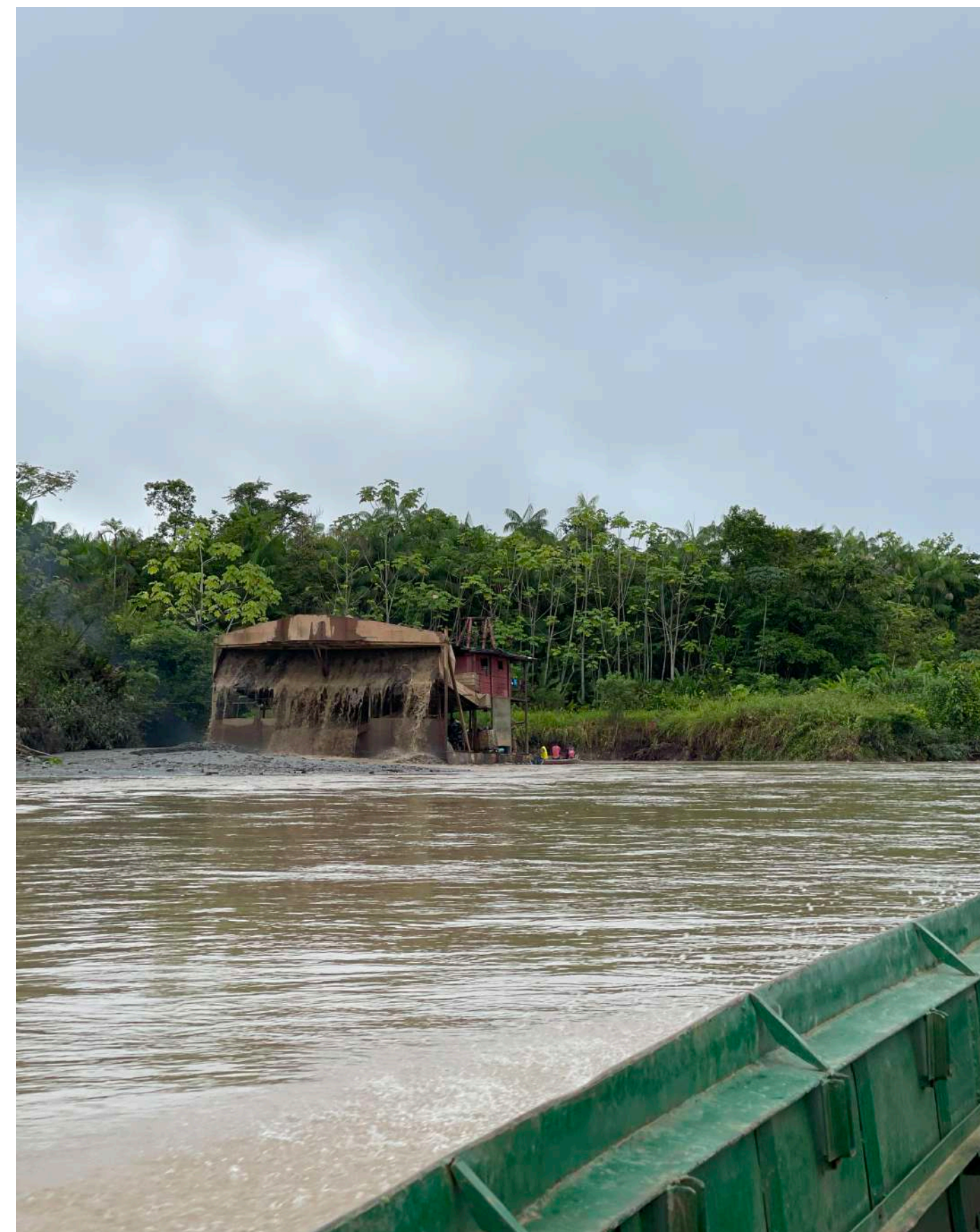
Fotografía 5. Desarrollo de actividad minera sobre el río Quito mediante el uso de dragas
