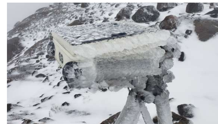
Fotografía 9. Las bajas temperaturas y alta humedad atmosférica durante La Niña 2021, impactaron algunos equipos de monitoreo glaciar como esta cámara de fotoseguimiento
