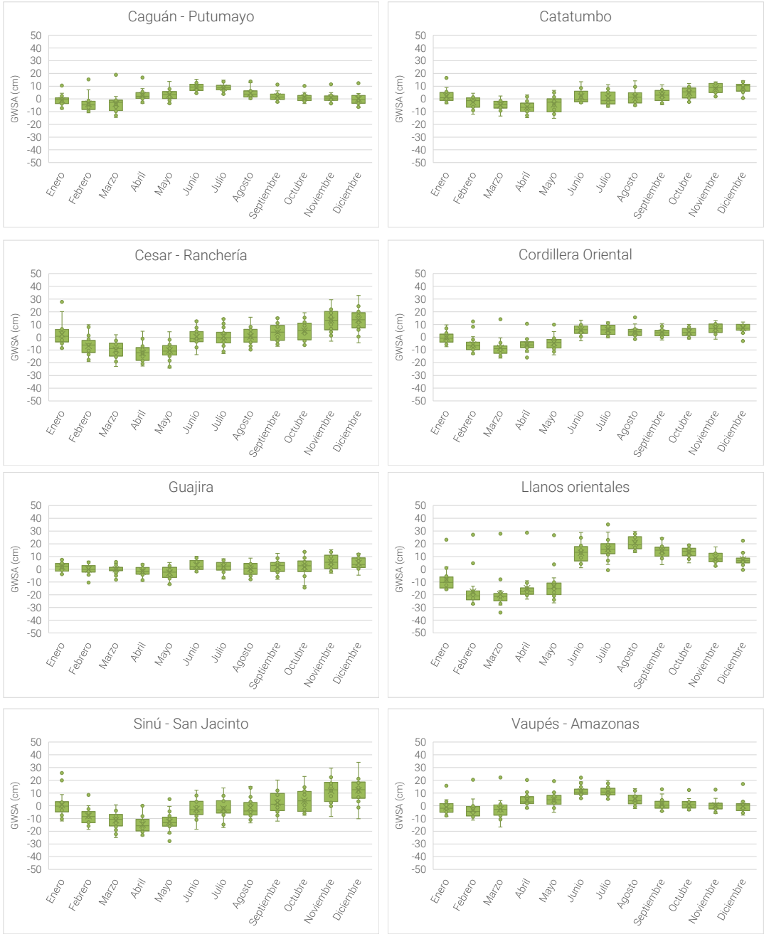
Figura 59. Serie de tiempo del promedio espacial-mensual de anomalías de almacenamiento de aguas subterráneas por provincias hidrogeológicas
