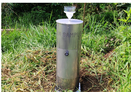
Figura 7. Izquierda: colector tipo Palmex estación Victoria Caldas – Acuífero Grande de la Magdalena. Derecha: colector artesanal construido por la UTP estación Vivero Torrecitas de Vivocuencia, Manizales – Caldas. Corpocaldas
