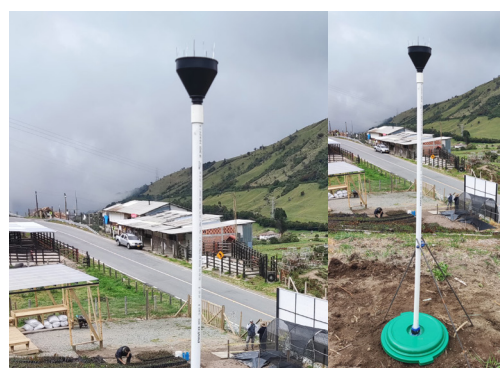
Figura 7. Izquierda: colector tipo Palmex estación Victoria Caldas – Acuífero Grande de la Magdalena. Derecha: colector artesanal construido por la UTP estación Vivero Torrecitas de Vivocuencia, Manizales – Caldas. Corpocaldas
