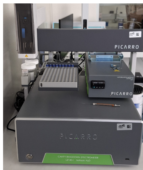
Figura 24. Analizador de isótopos estables en agua L2140-i.
