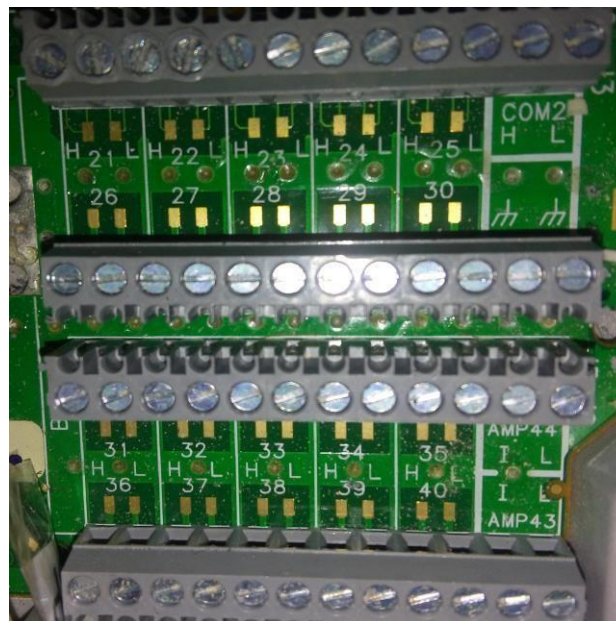
Figura 11. Numeración de las terminales del bloque terminal.
