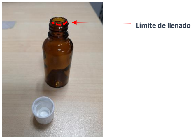
Figura 3. Fotografía del frasco utilizado para el muestreo de isótopos de Oxígeno 18 y Deuterio, donde se detalla el límite de llenado para evitar procesos de evaporación dentro del frascos.
