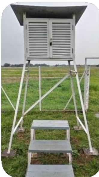
Figura 1. Garita meteorológica estación IDEAM
