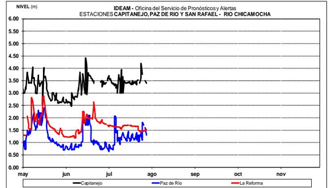
A la altura de la estación Puentes Sogamoso, el río Sogamoso mantiene las oscilaciones producto de la operación del embalse de Topocoro (Hidrosogamoso).
