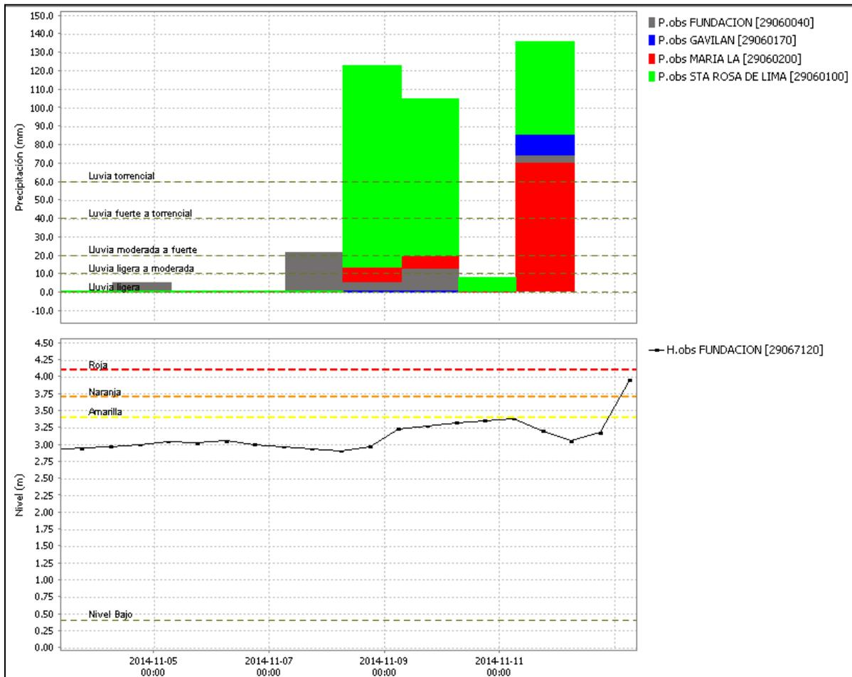
Estado actual de los niveles del río Fundación a la altura del municipio de Fundación en el Magdalena y las precipitaciones registradas en las estaciones meteorológicas ubicadas en la cuenca.
