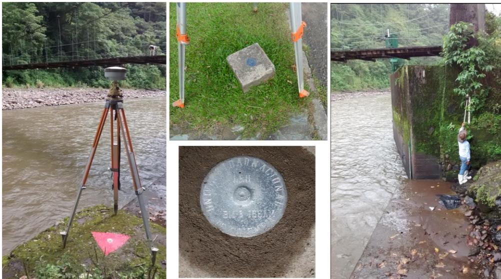
Fuente Subdirección de Hidrología Figura 11. Levantamiento cota cero y cota de inundación en Estación Puente Abadía
