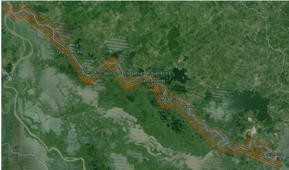
Fuente Subdirección de Hidrología Figura 5. Programación Líneas de Vuelo para levantamiento Lidar y aerofotografía
