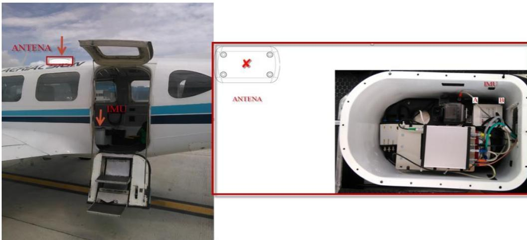
Fuente Subdirección de Hidrología Figura 6. Montaje equipos para la captura de datos Lidar y aerofotografía
