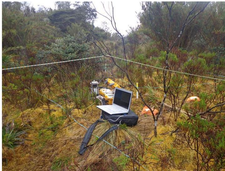
Fuente: Subdirección de Ecosistemas Figura 19. Instalación de los equipos de lectura de CO<sub>2</sub> (Licor8100) para la medición de flujos de CO<sub>2</sub> en los diferentes tipos de cobertura (Bosque y Páramo).
