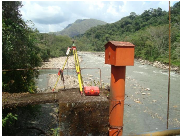
GPS de precisión geodésica sobre BM estación hidrológica.
