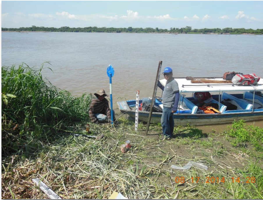
Foto 37. Nivelación miras estación Coyongal
