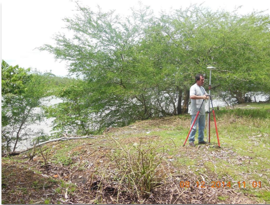
Foto 4. GPS (Base) sobre vértice en red densificada para la región La Mojana
