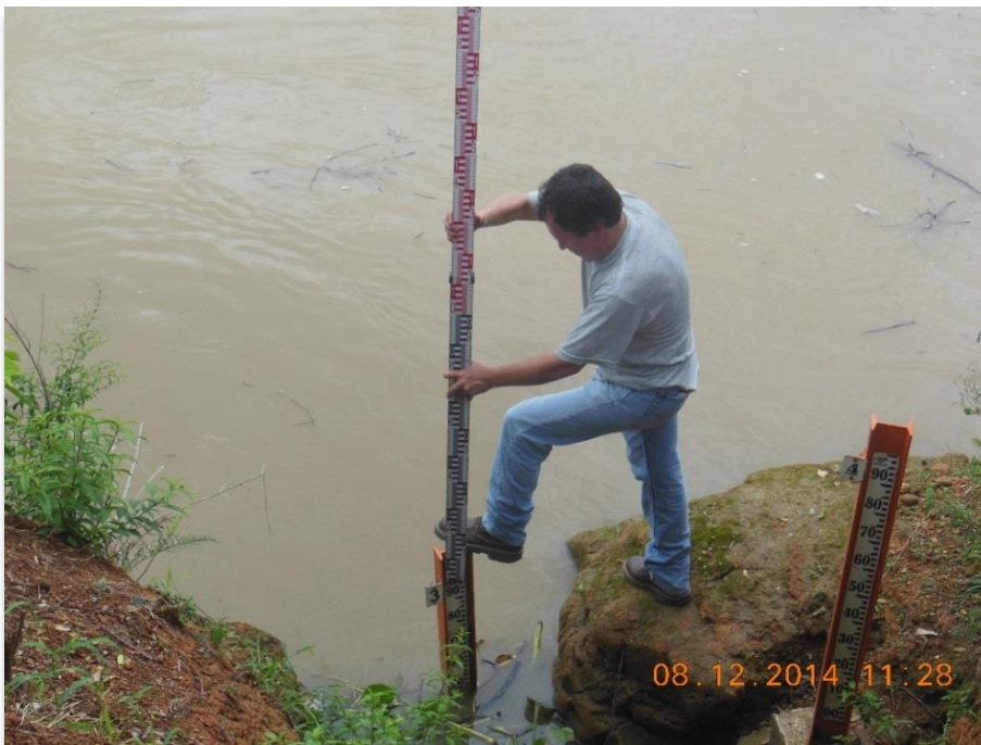
Foto 7. Nivelación de Miras y empalme de tramos.
