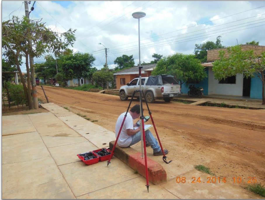
Foto 53. Vértice GPS-SU-T-38 para nivelación estación San Marcos.
