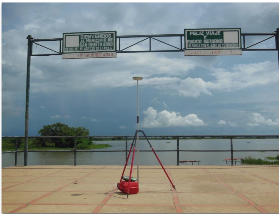
Foto 29. Equipo GPS Móvil para geo referenciar Estación Jegua Rio San Jorge
