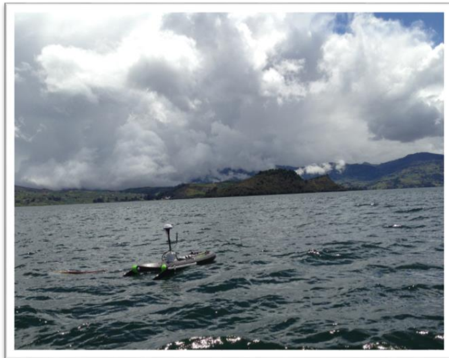
Fotografía 6. Equipo ADCP para el levantamiento batimétrico en el Lago de Tota
